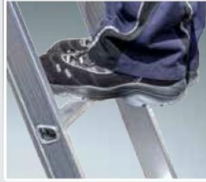
Sprossen mit 32 mm waagerechter Auftrittsfläche für sicheren und ermüdungsfreien Stand, Sprossenabstand 280 mm
